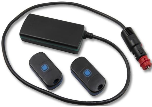
Die perfekte Ergänzung sind die Temperatursender ENAiKOON tag-02, die über BLE oder Lora mit dem Gateway kommunizieren. Die Temperatursender werden in die gekühlten Transportboxen gelegt und erfassen dort in regelmäßigen Abständen die Temperaturen. Die Batterien der Temperatursender müssen regelmäßig ersetzt werden, im Schnitt halten sie ca. 1 Jahr.
